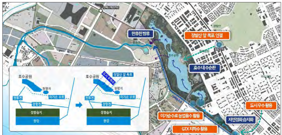
[그림 3-6] 호수공원 물순환 시스템
