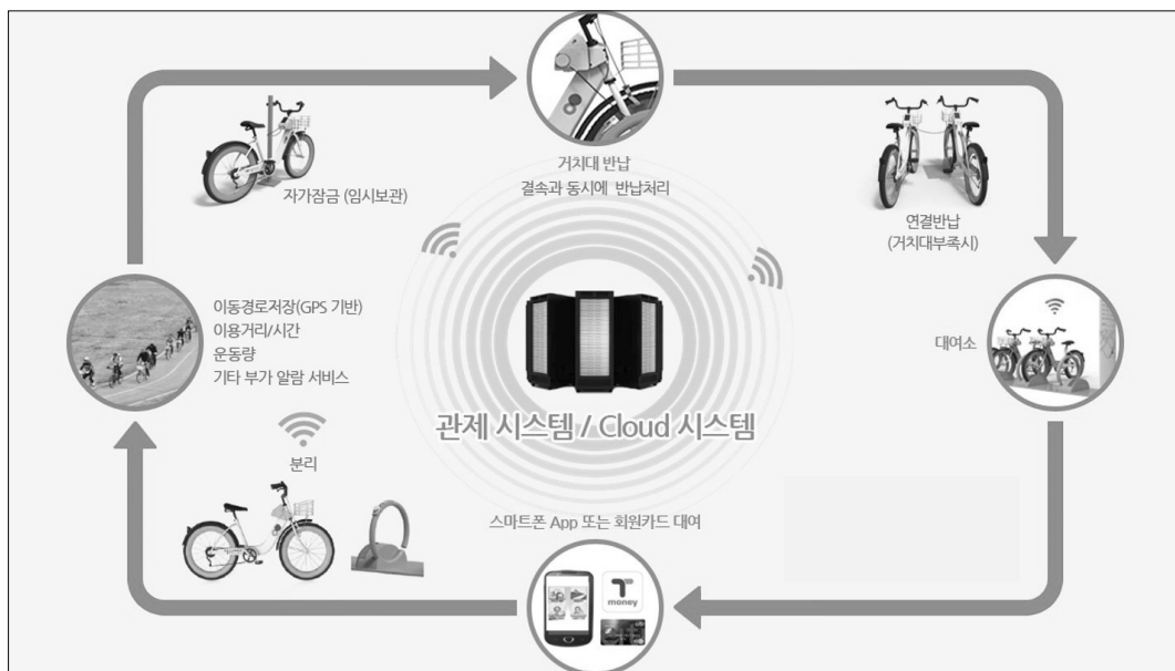
[그림 3-4] 공공(공영)자전거 운영 시스템 개요
